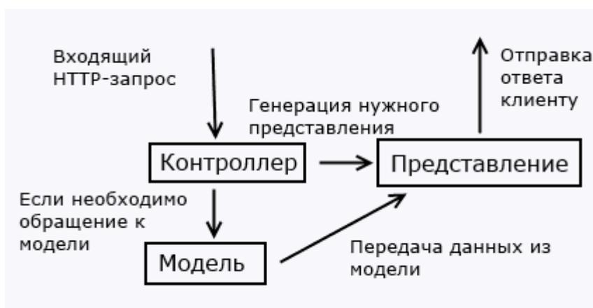
Рисунок 1 – схема “MVC”
